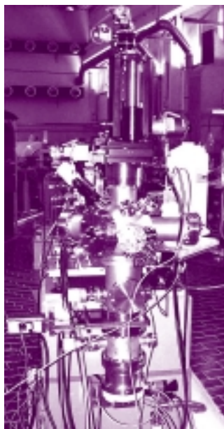
Fotografija žarkovne cevi z magnetnim kvadrupolnim lečjem, merilno postajo ter manipulatorjem vzorcev.
