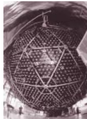
Slika 6: Detektor SNO v podzemni dvorani rudnika Creighton. Poleg cevi ogrođja so lepo vidne fotopomnoževalke – tokrat z zunanje strani. Pred meritvami jih priključijo na kable za električno napajanje in za branje signalov.
