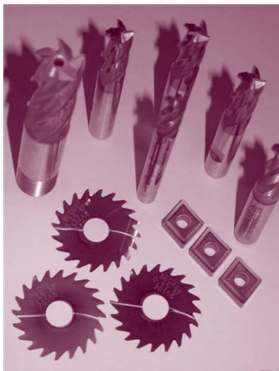
Slika 3. Frezala, žagice in rezalne ploščice iz karbidne trdine, prekrivane s TiAlN-prevleko
