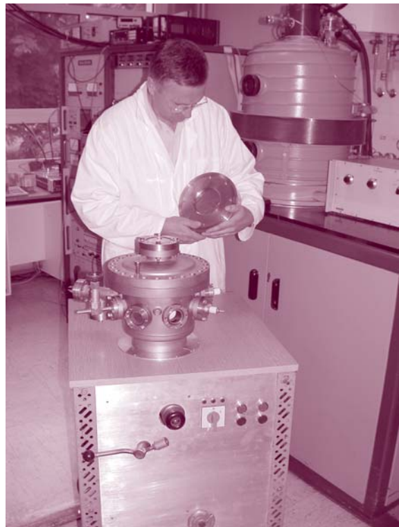
Slika 1. Balzersova eksperimentalna naprava Sputron (v ozadju), v kateri smo leta 1982 naredili prve TiN-prevleke na ploščate rezalne ploščice, in doma konstruirana naprava (v ospredju), v kateri smo lahko nanašali TiN-prevleke na orodja s komplicirano geometrijo (npr. svedri). Preizusi orodij v industrijski proizvodnji so bili zelo spodbudni.
