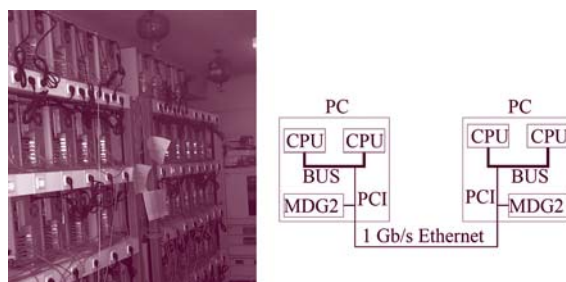
Slika 3: VRANA-7, eden od vzporednih računalnikov na Kemijskem inštitutu (levo), in shematski prikaz povezav med procesorji (CPU) ter namensko strojno opremo (MDG2) (desno) računalnikoma ter skupno stikalo Gigabit Ethernet, preko katerega so povezani vsi računalniki. Vsakemu od dvoprocorskih vozlišč je dodana kartica MD-GRAPE II, namenski procesor za hitro računanje sil dolgega dosega pri simulaciji molekulske dinamike, kar pospeši računanje nizkofrekvenčnega dela Hamiltonove funkcije. S tem se odlično dopolnjuje
