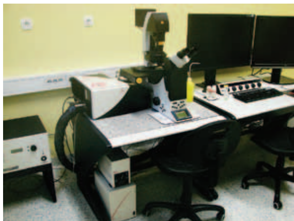
Slika 2: Konfokalni mikroskop LEICA TCS SP5 X z belim laserjem (levo spodaj), skenirno glavo z detektorji, ohišjem invertnega mikroskopa ter kontrolnimi enotami za motorizirano upravljanje
