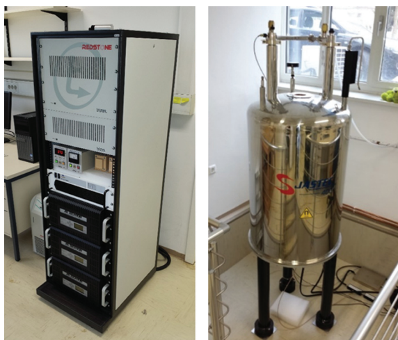
Slika 1: Nov sistem za magnetnoresonančno mikroskopijo je sestavljen iz spektrometra z RF- in gradientnimi ojačevalniki (levo) in pokončnega superprevodnega magneta z gostoto magnetnega polja 9,4 T (desno).
