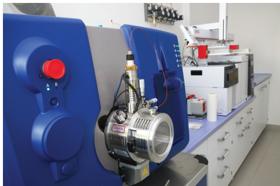
Slika 5: LC-Qtrap tekočinski kromatograf s hibridnim masnim spektrometrom za analizo polarnih organskih spojin. Instrument je sestavljen iz tekočinskega kromatografa, UV-VIS-detektorja, ionskega izvira ESI in APCI ter tandemskega masnega spektrometra (Q1-Q2-Q3).
