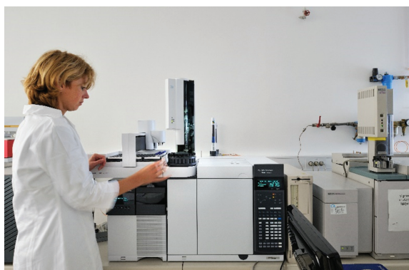
Slika 6: GC-MSD plinski kromatograf z masno-selektivnim detektorjem za analizo organskih onesažil.
