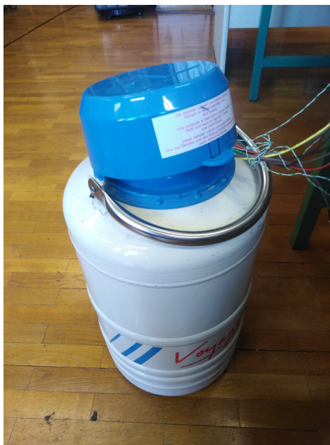
Slika 4.8: Posoda s tekočim dušikom.
