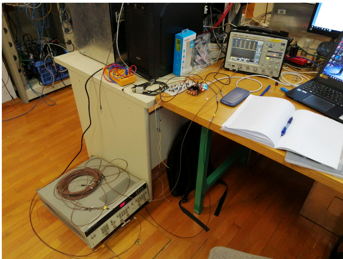
Slika 4.15: Določanje ločljivosti izdelanega TDCja na Red Pitayu z generatorjem HP8130A, katerega izhod razdelimo na dva kabla.
