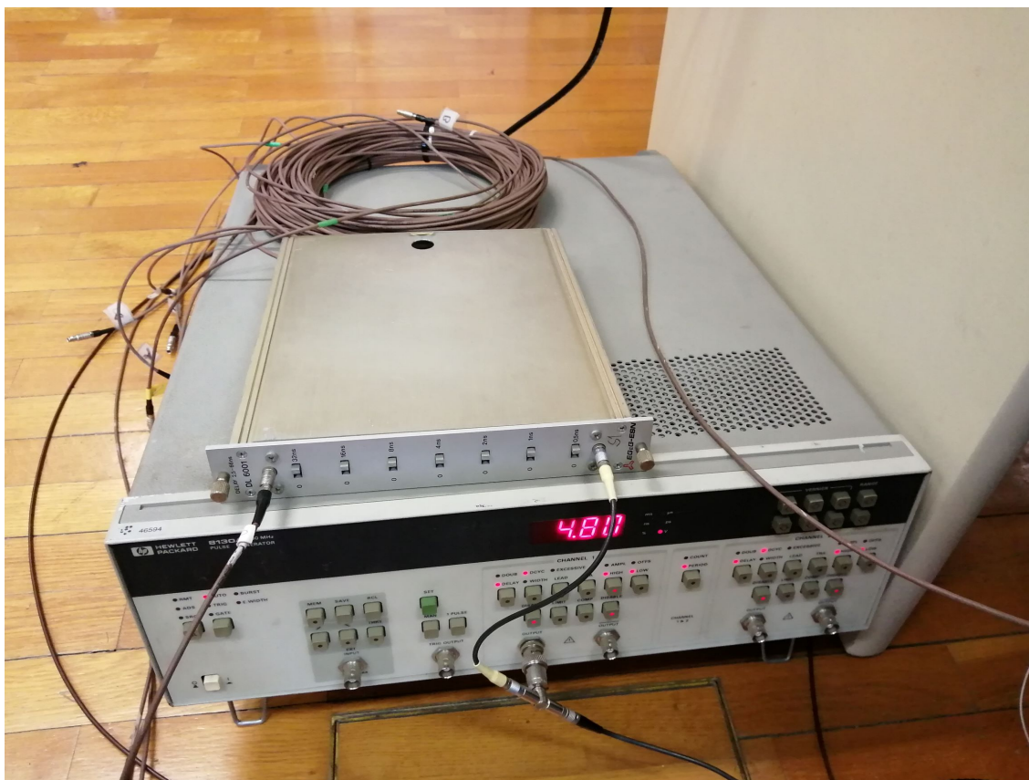
Slika 4.18: Dodatno zakasnitev ustvarimo zelo enostavno: v linijo dodamo dolge kable.
