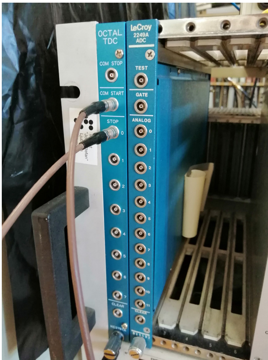
Slika 5.6: Referenčni 8-kanalni NIM TDC Kaizuworks KC3781A s časovno ločljivostjo 25 ps. Na kanal START priklopimo sinhronizacijski izhod laserja, na STOP pa izhod iz diskriminatorja.
