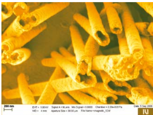
Slika 1: (levo) Cevaste nanostrukture na osnovi zlitine Co-Pt, sintetizirane z neposredno elektrodepozicijo; (desno) magnetne lastnosti cevastih nanostruktur Co-Pt pred termično obdelavo in po njej
