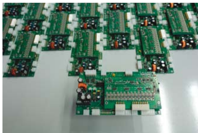
Slika 4: SmartModul – merilno-regulacijski sistem za razdeljevanje zraka pri napajanju kogeneracijskih naprav na osnovi gorivnih celic
