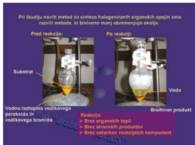
Slika 3: 'Zeleno' halogeniranje organskih spojin v vodi
