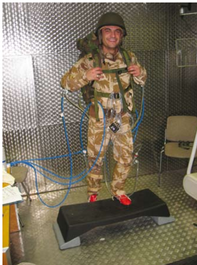
Slika 4: Ocenjevanje vojaške opreme za delo v puščavskih okoljih v klimatski komori
