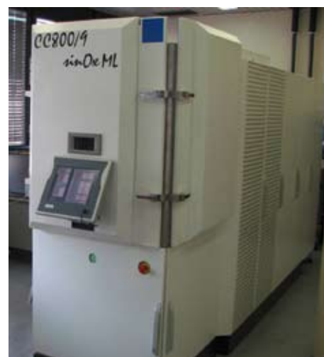
Slika 1: Nova naprava za nanos trdih prevlek CemeCon CC800/9 sinOx ML
