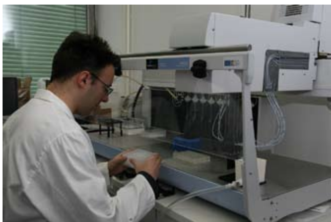
Slika 2: Novi sistem JANUS omogoča avtomatizirano postopanje s tekočinami, vključno s tripsinsko razgradnjo kot delom priprave vzorca za nadaljnjo analizo z masnim spektrometrom.
