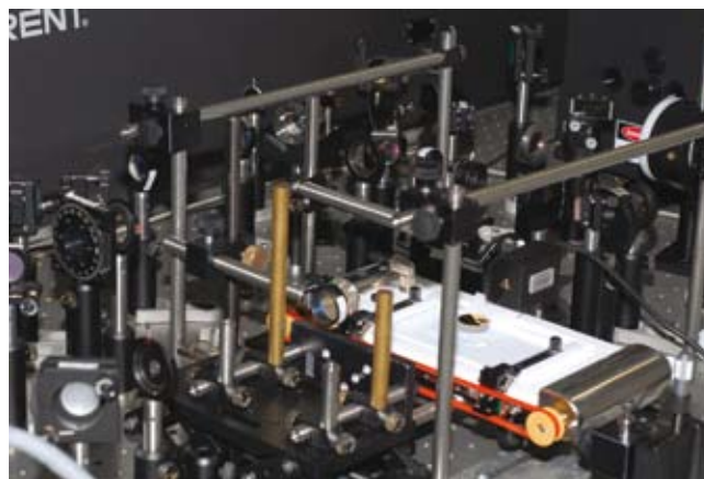
Slika 4: Slika eksperimenta z nelinearno optično spektroskopijo (IR-VIS SFG) Langmuirjevih plasti biomolekul na vodni površini
