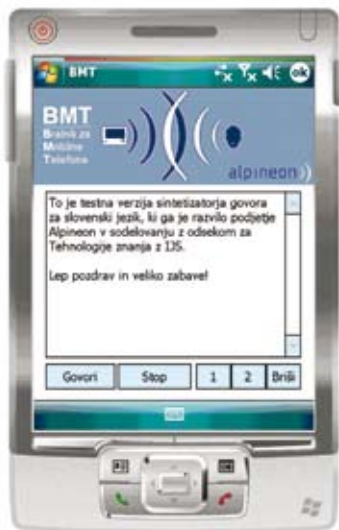
Slika 3: Prototip sintetizatorja govora, razvitega v okviru projekta »BMT: razvoj glasovnega bralnika besedil za mobilne telefone za slepe in slabovidne uporabnike«.
