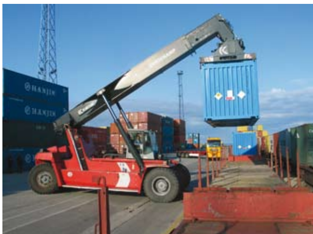
Slika 2: Prelaganje zabojnikov z vsebniki za prevoz jedrskih gorivnih elementov
