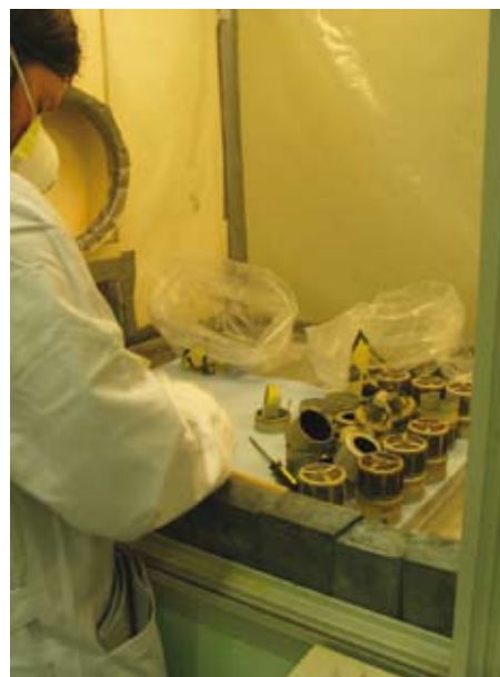
Slika 5: Razstavljanje javljalnikov požara z vsebnostjo americija-241 v okviru projekta Izboljšanje ravnanja z institucionalnimi radioaktivnimi odpadki v Sloveniji
