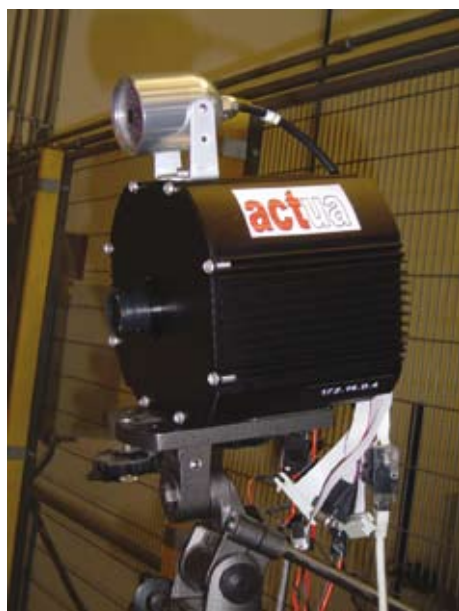
Slika 2: Rezultat projekta OP6 Arflex: vgrajeni sistem robotskega vida (pametna kamera)
