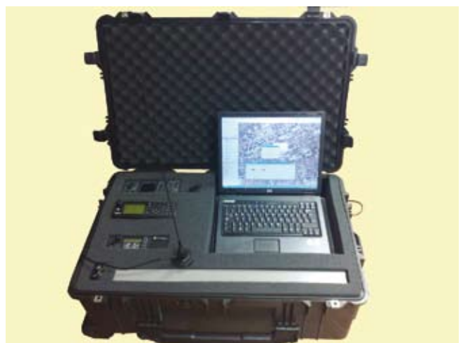
Slika 1: Integrirana mobilna naprava za merjenje, zapisovanje, prikaz in analizo nivoja signala sistemov mobilnih radijskih zvez zaščite in reševanja ZARE, ZARE+, DMR in TETRA
