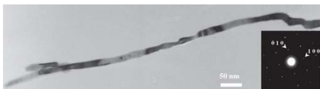
Slika 4: TEM-BF-posnetek perovskita \text{KNbO}_3 vzdolž [001] in pripadajoča uklonska slika SAED. Odsek za sodobne materiale: I. Pribošič, D. Makovec
