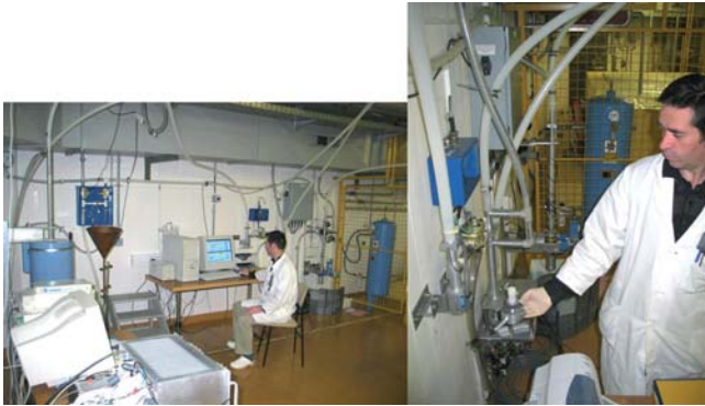
Slika 2: S sistemom hitre pnevmatske pošte (FPTS) se je čas prenosa vzorca iz središča reaktorja do merilnega mesta (HPGe-detektor) skrajšal na 1 s. Uporablja se pri instrumentalni nevtronski aktivacijski analizi kratkoživih izotopov.
