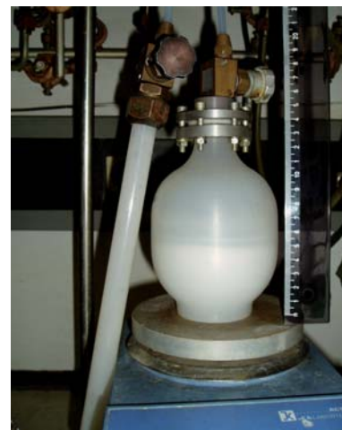
Slika 2: Reakcijska posoda (700 mL) za pripravo AlF_3 z veliko površino v tekočem brezvodnem HF
