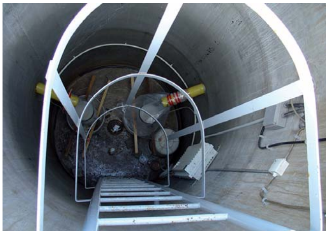
Slika 4: Lizimetska postaja Kleče pri Ljubljani: zbiranje podtalnice na neomesnaženem travnišču za analizo naravnega ozadja onesnažil, ki ogrožajo nahajališča pitne vode na področju Ljubljanskega polja
