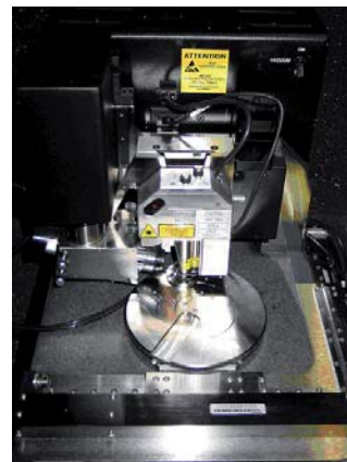
Slika 4: Tipalni mikroskop Dimension 3000, nabavljen iz sredstev ESRR, je najnovejši v Sloveniji. Omogoča atomsko ločljivost v kombinaciji z zelo prijazno uporabnostjo.
