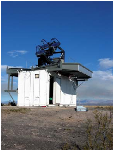
Slika 3: Postaja LIDAR sredi argentinske pampe. Naš prispevek k detektorju Pierre Auger se uporablja za meritev sipane laserske svetlobe za spremljanje prepustnosti atmosfere, kar je izjemnega pomena za pravilno razlago podatkov iz fluorescenčnega detektorja.
