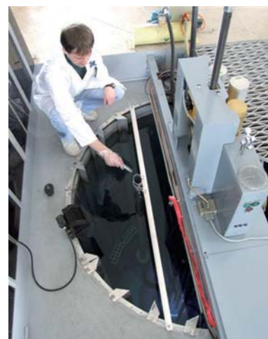
Slika 1: Obsevanje različnih aditivov za nov način priprave kompozitnih materialov \text{SiC}_x/\text{SiC} , ki jih razvija Odsek za nanostrukturne materiale za prvo steno bodočega fuzijskega reaktorja.
