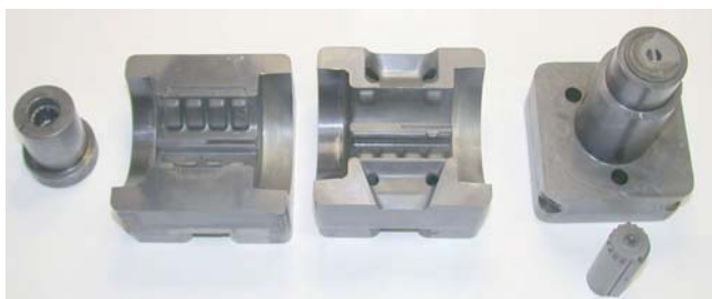
Slika 4: Lasersko sintrano orodje za tlačno litje aluminija, zaščiteno s prevleko TiAlN
