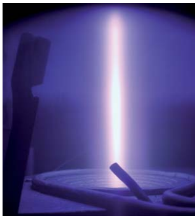
Slika 3: Plazma v napravi za nanos trdih prevlek Sputron s termoionskim lokom
