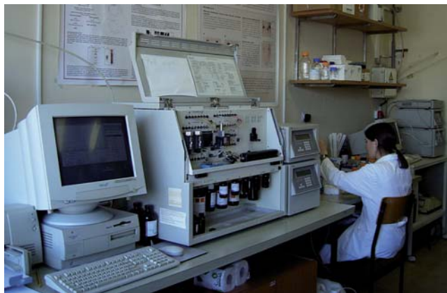
Slika 3. Pomemben del proteomike je strukturna identifikacija proteinov. Instrument za določanje strukture proteinov po Edmanovi metodi.
