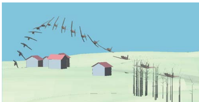
Slika 2: Simulacija nesreče letala Pilatusa PC-9 pri Spodnjih Žerjavcih 3. 3. 2004 po trku z drevesom. Pogled v smeri zahod-severozahod. R. Krivec; tehnično poročilo za MORS.
