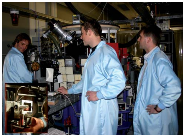
Slika 1: Prof. Heinrich Schworer, Kay-Uwe Amthor in dr. Tomaž Žagar pripravljajo detektorje hitrih protonov in nevtronov odseka F8 v zaščiten vakuumski prostor s tarčami multi-TW Ti:sapphire-laserja Univerze v Jeni, Nemčija.
