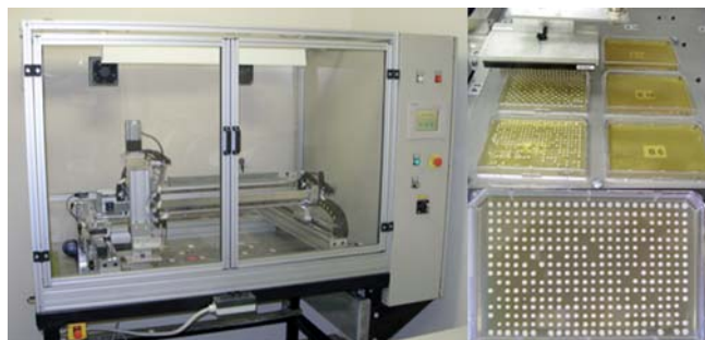
Slika 2: Novi robot za avtomatsko replikacijo urejenih kolonij mikroorganizmov (kvasovk)
