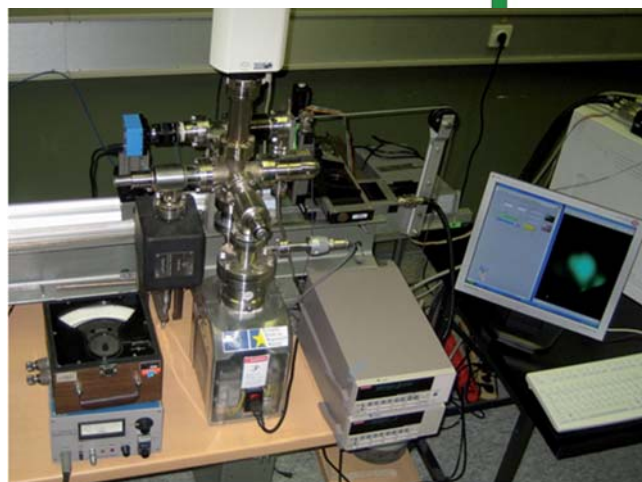
Slika 5: Shema ključnih sestavnih delov (zgoraj) in slika celotnega merilnega mesta za delo s poljskim projekcijskim mikroskopom (spodaj)
