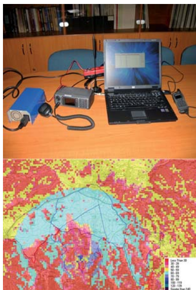
Slika 3: Meritve pokritosti s signalom TETRA v pilotskem omrežju TETRA za potrebe MORS
