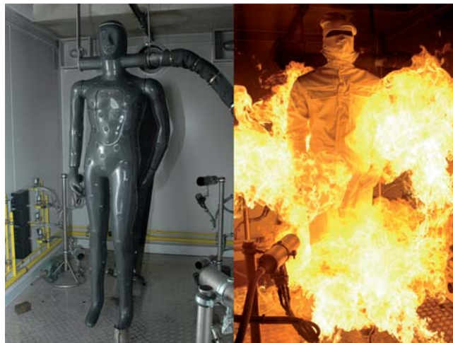
Slika 5: Preizkušanje v komori za simulacijo eksplozijskega požara
