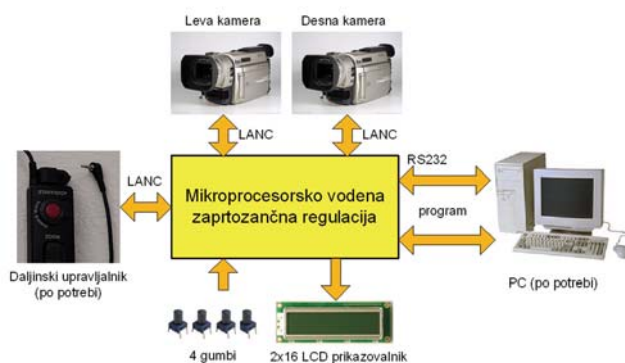
Slika 1: Blokovna shema sinhronizatorja video- in slikovnih kamer (3D LANC Master)
