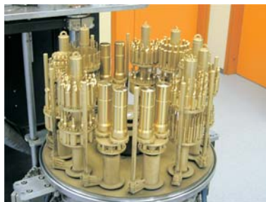
Orodja, zaščiteni s TiN prevleko (Avtor posnetka: P. Panjan)
