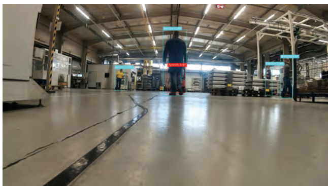
Slika 3: Sistem za prepoznavanje objektov integriran v FPGA AGV
