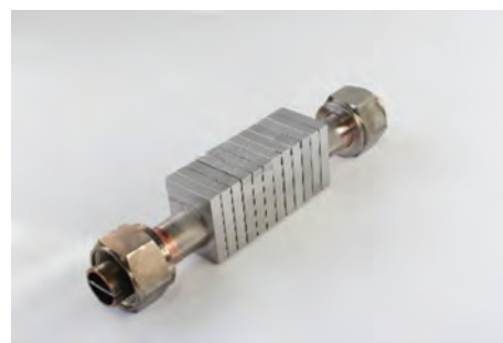
Slika 5: Monobloki, spojeni s hladilno strukturo \text{CuCrZr} , po HHFT testiranju v aktivno hlajenem modelu divertorja.
