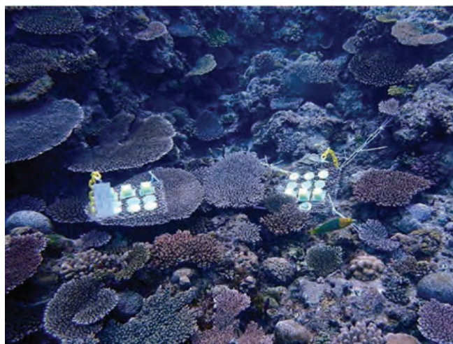
Slika 10: 3D natisnjeni substrati za obnovo koral, nameščeni pri Onna-son, Okinawa, Japonska.
