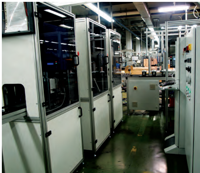
Slika 6: Diagnostični sistem za popolno končno kontrolo elektromotorjev tipa 462 na proizvodni liniji v podjetju Domel, d. o. o.
