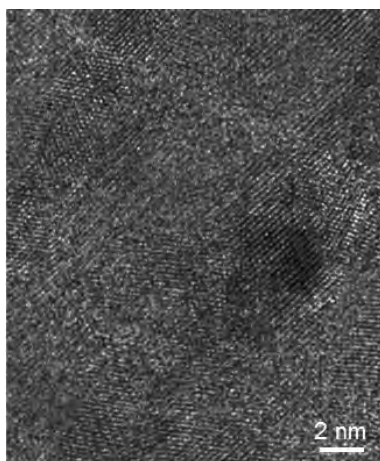
Slika 2: HRTEM-posnetek v prerezu nanokompozitne prevleke TiSiN, ki je sestavljena iz nanodelcev TiN in amorfne faze Si 3 N 4 (avtor posnetka: doc. dr. Goran Dražič)
