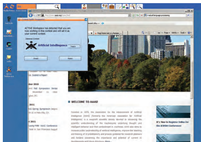
Slika 3: Sistem za zaznavanje sprememb delovnih kontekstov, razvit v evropskem projektu ACTIVE. Ko uporabnik uporabi kak informacijski vir, ki spada v določen kontekst, kot na primer spletno stran ali dokument z besedilom (v tem primeru vsebina spletne strani zazna kontekst »Artificial Intelligence«), se sistem prilagodi na to spremembo ter zna glede na to predlagati druge informacijske vire, povezane s tem kontekstom.
