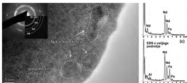
Slika 2 A: Visokoločljivostni posnetek neobdelanega vzorca pokaže, da je vzorec sestavljen iz kristaliničnih nanodelcev v amorfni matrici. (a) Uklonski posnetek z izbranega področja pokaže, da so nanodelci heksagonalni neodim z medmrežnimi razdaljami: d_1 = 0,3116 nm, d_2 = 0,2914 nm, d_3 = 0,2760 nm, d_4 = 0,2126 nm, d_5 = 0,1835 nm in d_6 = 0,1639 nm; (b) EDS-analiza z neodimovega nanodelca; (c) EDS-analiza s širšega področja.
