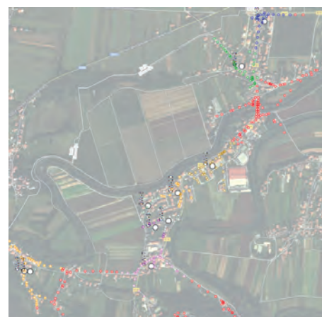
Slika 5: Optimalna lokacije prehodov, določena s TopoSWiM, programskim orodjem za načrtovanje topologije obsežnih brezžičnih zankastih omrežij
