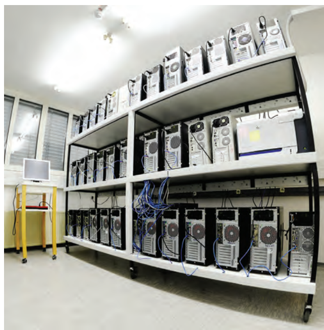
Slika 4: Superračunalniški sistem, imenovan PARS, s 330 jedri (Intel Xeon in AMD Opteron) in 1 080 GB delovnega spomina, ki ga poganja operacijski sistem Debian GNU/Linux. Superračunalnik so sestavili in ga sami vzdržujejo sodelavci odseka.
