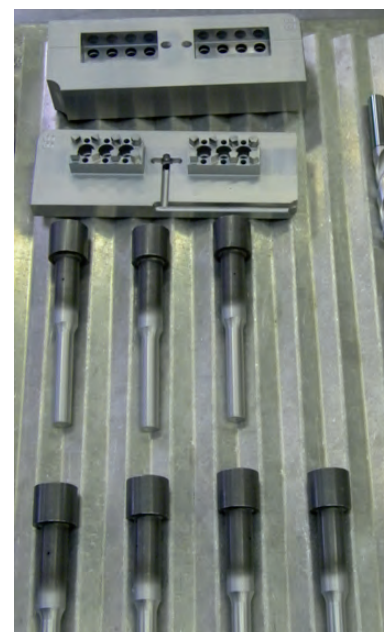
Slika 1: Rezalna in preoblikovalna orodja, prekrita s kvazikristalno prevleko AlCuFeB
