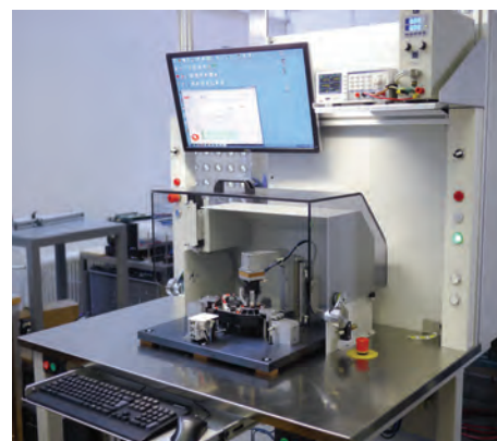
Slika 5: Diagnostični sistem za končno kontrolo elektromotorja za električni pogon za kolesa
