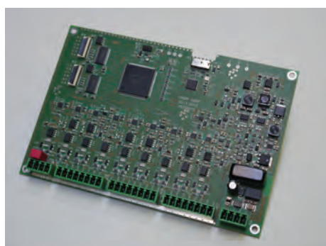
Slika 3: Namensko razviti elektronski modul za sistem membranskega čiščenja vodika
