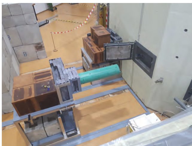
Slika 5: Lani je bila instalirana obsevalna naprava v kanal 5 z namenom obsevanja velikih fisijskih celic. Spremenjen kanal uporablja Rolls Royce Civil Nuclear S.A.S.
