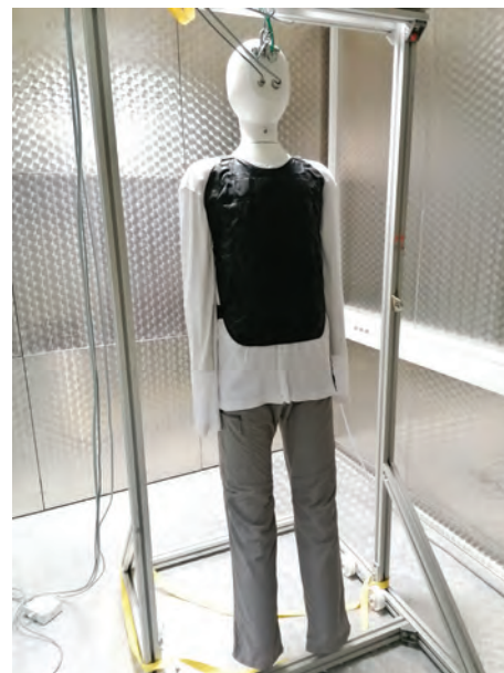
Slika 7: Manikin za testiranje zaščitnih oblačil
