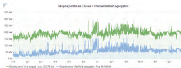
Slika 4: Poraba električne energije odraža intenzivnost rabe računskega centra, v katerem gostujejo računsko intenzivne superračunalniške skupine. Iz porabe je razvidno učinkovitejše hlajenje v hladnih mesecih, ko je mogoče hladilni medij ohlajati le z zunanjim zrakom brez uporabe kompresorja, ter povečano porabo v jeseni, saj je povečanje uporabe zahtevalo vzporedno delovanje obeh hladilnih agregatov.
