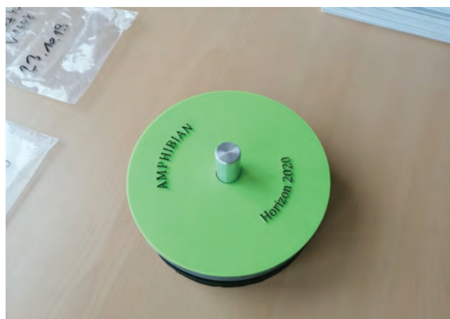
Slika 3: Prototip vztrajnika, kjer so magneti Nd-Fe-B zamenjali feritni magneti.
