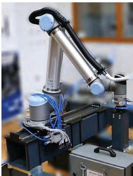
Slika 2: Pasivna linearna stopnja razvita v projektu ReconCell za rekonfiguracijo robotskih celic
