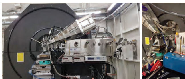
Slika 5: Spektrometer za meritve rentgenskega ramanskega sipanja (XRS) na žarkovni liniji P01 sinhrotrona PETRA III na DESY v Hamburgu. (desno) Eksperimentalna postavitev pri meritvah XRS na bateriji med praznjenjem.
