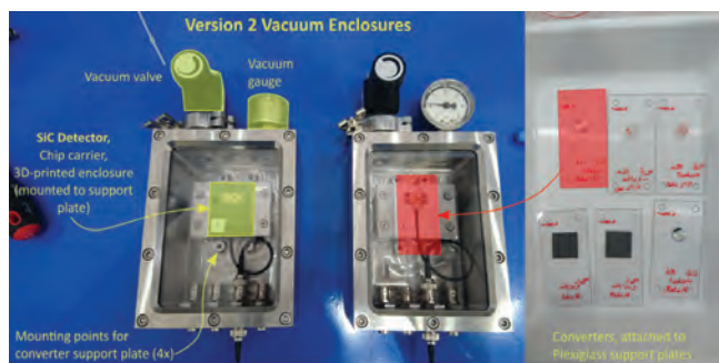
Slika 1: Prototipna detektorja nevtronov na osnovi silicijevega karbida (SiC), razvita v okviru projekta E-SiCure, ki sta bila testirana v reaktorju TRIGA na IJS. Detektorji so sestavljeni iz Schottkyjevih diod in SiC in okrog 2 µm tankih konverterjev nevtronov v nabite delce v obliki tankih plasti 10 B 4 C ali 6 LiF na aluminijastem substratu in delujejo v vakuumu.
