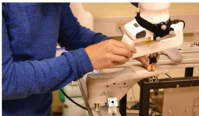
Slika 3: Programiranje zaključnih operacij pri izdelavi čevljev s kinestetičnim vodenjem
