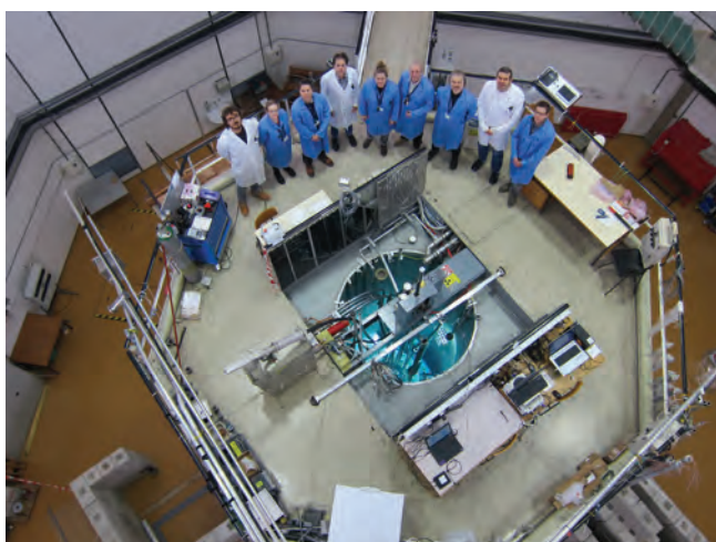
Slika 3: Precision Acoustics, TWI in Ionix razvijalci ultrazvočnih senzorjev med testno kampanjo na reaktorju TRIGA
