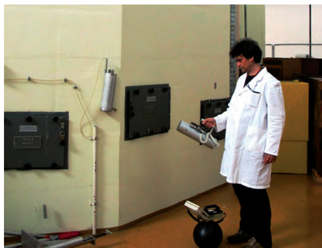
Slika 1: Meritve hitrosti doze ob tangencialnih kanalih v hali reaktorja TRIGA MARK II
