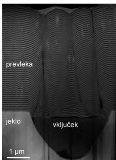
Slika 2: Prevez večplastne strukture TiAlN/CrN na mestu vključka MnS, posnet s presevno elektronsko mikroskopijo
