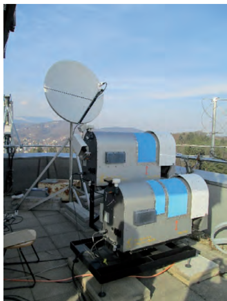
Slika 2: Satelitski sprejemnik Alphasat, ki smo ga razvili na IJS in v sodelovanju z inštitutom Joanneum Reseach, namestili pa na Hilmwarte stolpu v Gradcu, Avstrija
