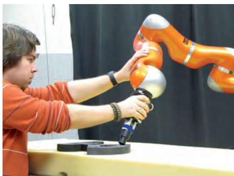
Slika 4: Učenje s posnemanjem ob upoštevanju sil, ki nastanejo pri robotskih nalogah v stiku z okoljem
