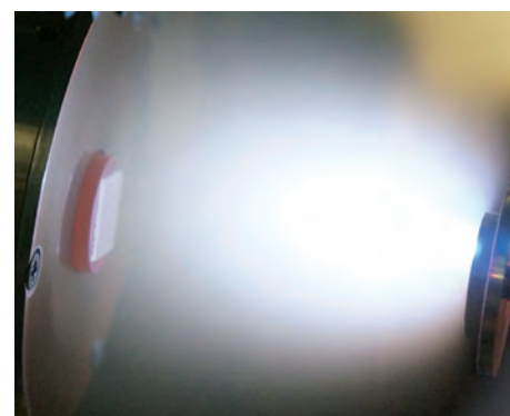
Slika 8: Plazma, ustvarjena med lasersko ablacijo keramične tarče Ag(Nb 0,5 Ta 0,5 )O 3 pri energiji laserja 1,5 J/cm 2 in parcialnem parnem tlaku kisika 0,1 mbar v sistemu za pulzno lasersko nanašanje
