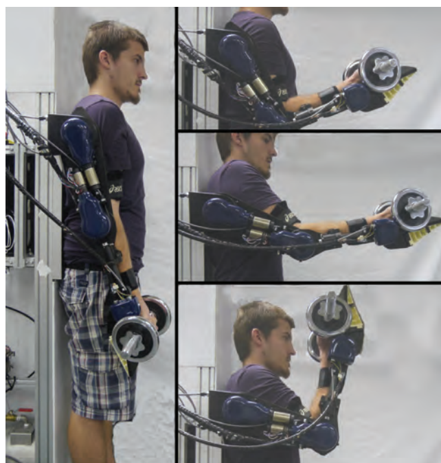
Slika 4: Premikanje uteži z uporabo eksoskeleta
