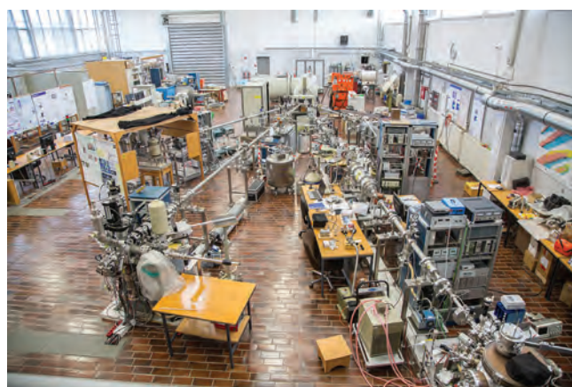
Slika 6: Tandemski ionski pospeševalnik "Tandemron" 2 MV s štirimi žarkovnimi linijami (Foto M. Verč)
