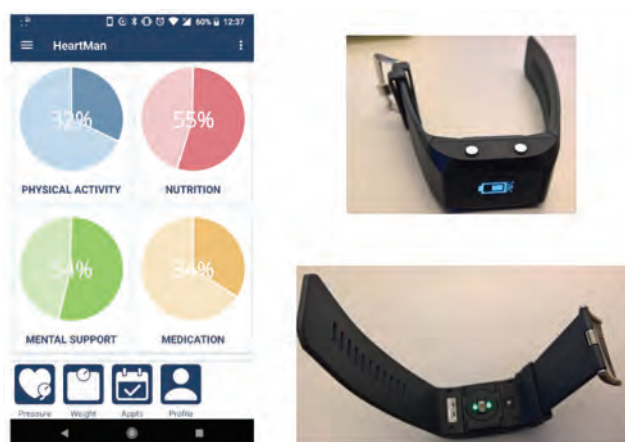
Slika 4: Mobilna aplikacija HeartMan, ki bolnikom s srčnim popuščanjem pomaga pri obvladovanju njihove bolezni, in senzorska zapestnica, s katero aplikacija zajema fiziološke signale bolnikov.
