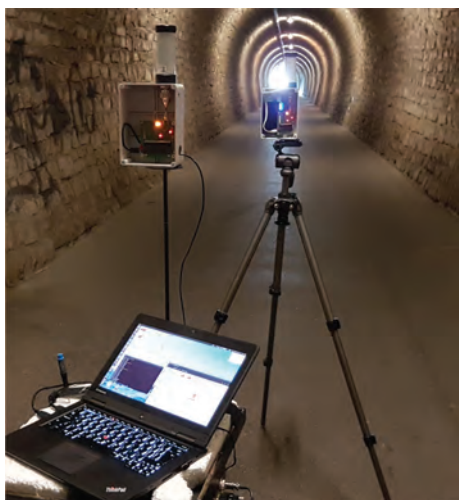
Slika 1: Modeliranje radijskega kanala za komunikacije do vozil v predorih
