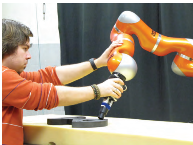
Slika 3: Kinestetično programiranje robotske roke
