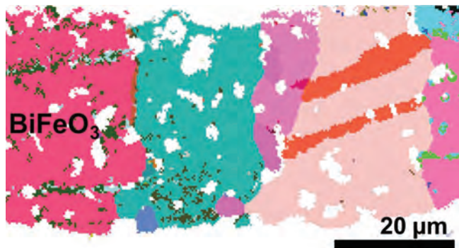
Slika 3: Porazdelitev kristalografskih orientacij v stebričastih zrnih z izraženo domensko strukturo v debeli plasti \text{BiFeO}_3
