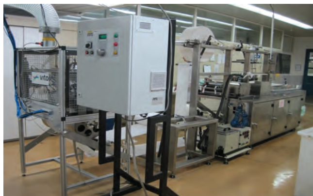
Slika 9: V proizvodnjo linijo pri Tosami smo v okviru EU-projekta IP4Plasma integrirali plazemski reaktor za nanos protibakterijske plasti na medicinske tekstilije.
