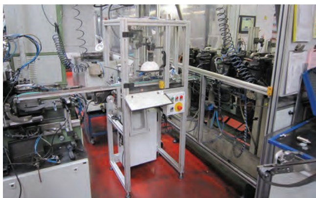
Slika 3: Sistem za nadzor kakovosti v proizvodnji, ki je rezultat mednarodnega projekta COPCAMS, temelji na strojnem vidu, strojnem učenju in optimizaciji.
