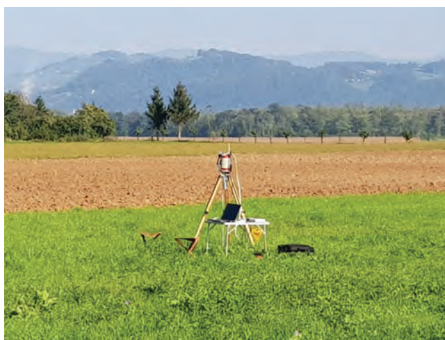
Slika 1: Meritve sevanja gama in situ z visokoločljivostnim spektrometrom HPGe v okviru programa merilnega nadzora radioaktivnosti v naravnem okolju
