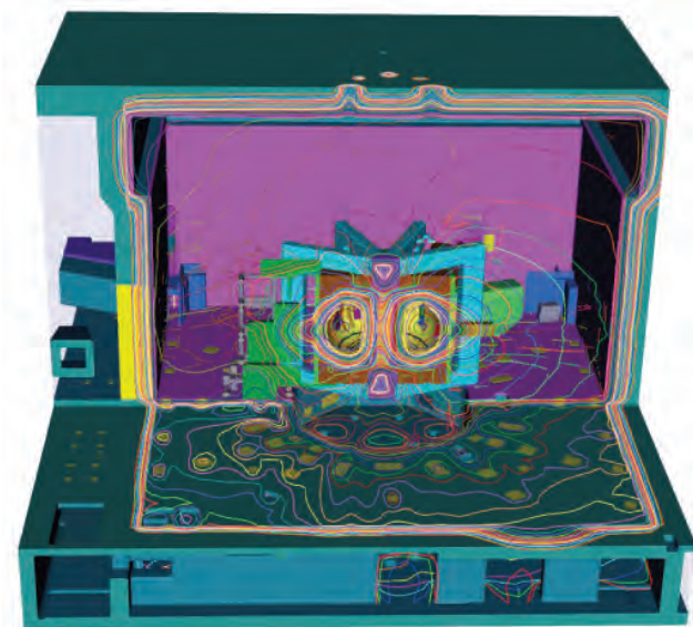
Slika 3: Grafična upodobitev celotnega 3D-modela tokamaka JET, uporabljenega za preračune eksperimentov strujanja. Konture pomenijo nevtronski fluks, ki izvira v DT-plazmi v vakuumski posodi, izračunan z determinističnim programom diskretnih ordinat za simulacijo transporta nevtronov.
