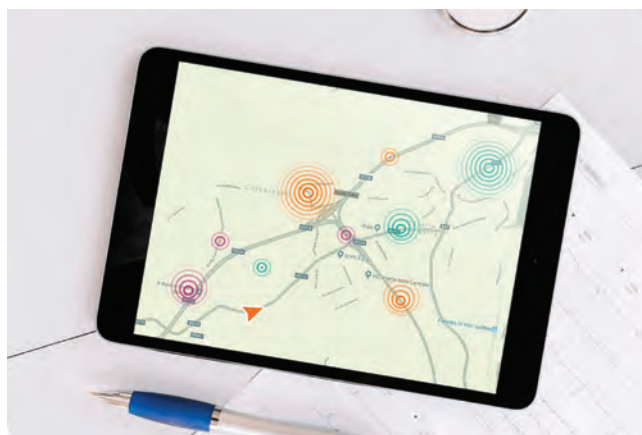
Slika 4: Kontekstno ozaveščeni alarmi na osnovi platforme MANTIS, namenjeni vzdrževanju železniških kretnic, z večbarvnimi animiranimi indikatorji, so nameščeni na zemljevidu
