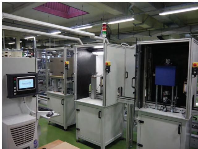
Slika 4: Diagnostični sistem za končno kontrolo elektromotorjev na novi proizvodni liniji ML-13 v Domelu, d. o. o.
