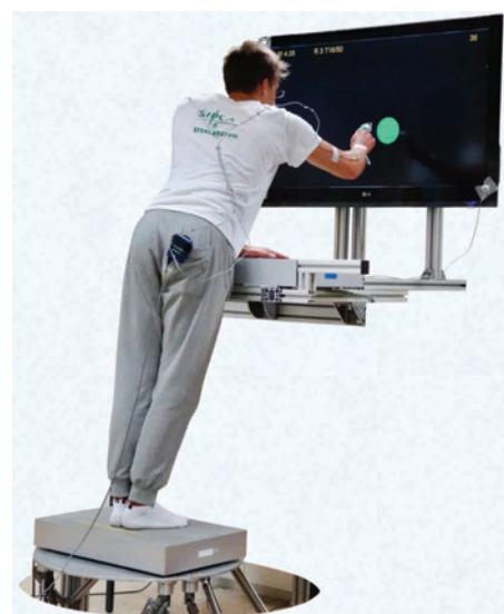
Slika 5: Eksperimentalna postavitev za raziskave mehanizmov človekovega motoričnega vodenja v kontaktu z okoljem
