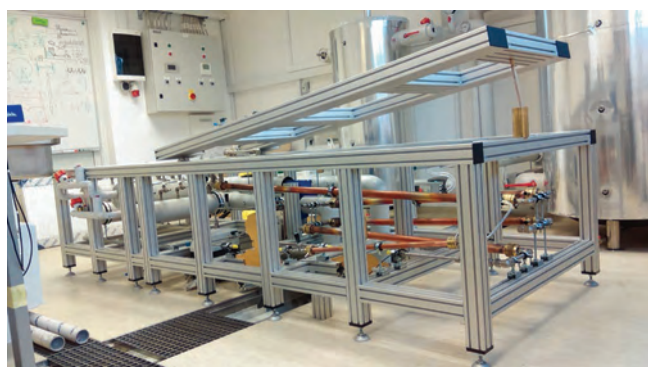
Slika 1: Eksperimentalna merilna proga za raziskave mehanike tekočin in prenosa toplote v gradnji
