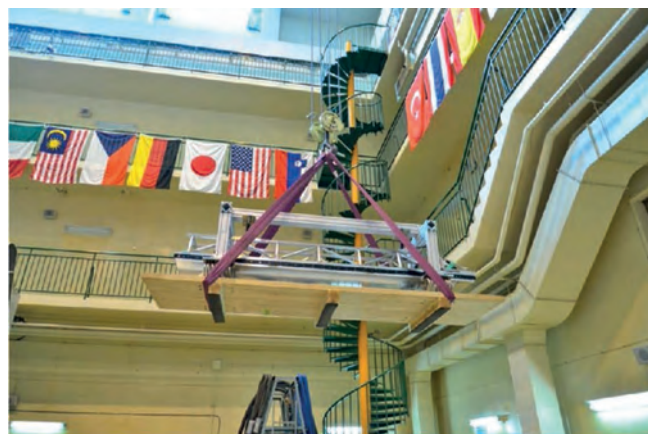
Slika 3: Transport enega od 16 modulov detektorja TOP v eksperimentalno dvorano spektrometra Belle II. Pri pripravi tega sklopa sodelujejo fiziki iz Japonske, ZDA, Italije in Slovenije.
