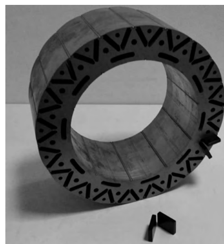
Slika 5: Magneti, ki so bili razviti na odseku v okviru projekta ROMEO, vstavljeni v motor električnega vozila podjetja Valeo. Preizkus elektromotorja je pokazal 13 % višjo zmogljivost in 11 % višji navor pri \Delta T = 95 K v primerjavi z referenčnim motorjem. Oba parametra tako vplivata na boljši izkoristek.
