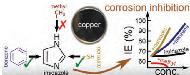
Slika 2: Vpliv posameznih derivatov imidazola na učinkovitost inhibicije korozije bakra v kloridni raztopini
