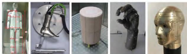
Slika 7: Manikini za vrednotenje toplotne izolacije in evaporativnih zmogljivostih oblačilnih sistemov
