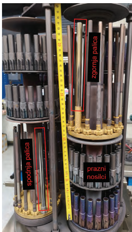
Slika 3: Primer postavitve testne šarže v napravi za industrijsko nanašanje; polirane palice iz hitroreznega jekla smo uporabili za zvezno ovrednotenje lastnosti prevleke po višini.
