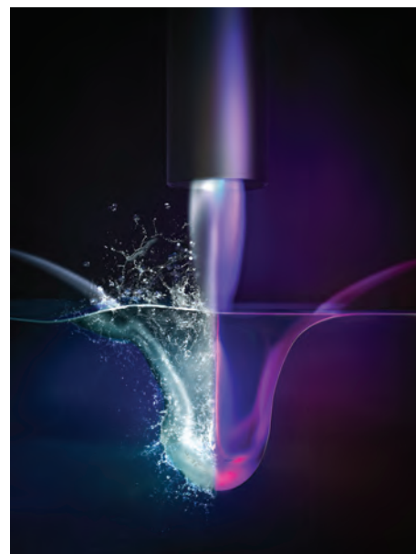
Slika 1: Shematski prikaz plazemskega curka, ustvarjenega pri atmosferskem tlaku, ki deluje na vodno površino in jo stabilizira.
