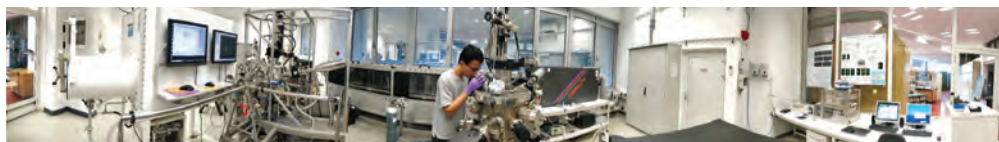
Slika 3: Levo: UHV PLD, desno: HV PLD-sistem, zadaj: UV-laser z optično potjo.
