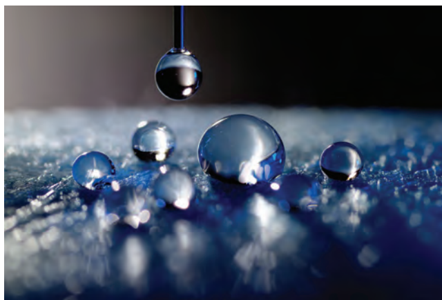
Slika 6: Slika prikazuje doziranje vodne kapljice na površino tkanine za maske. V primeru plazemsko obdelane površine se vodna kapljica absorbira.
