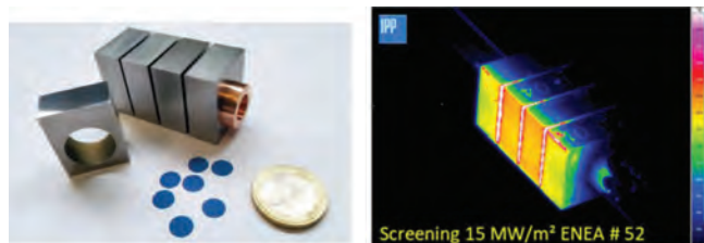
Slika 10: W-11WC monobloki, spojeni s CuCrZr (levo); enak sestav izpostavljen termični obremenitvi 15 MW/m 2 in hlajen s hladilno tekočino v cevi s temperaturo 18° C (desno).
