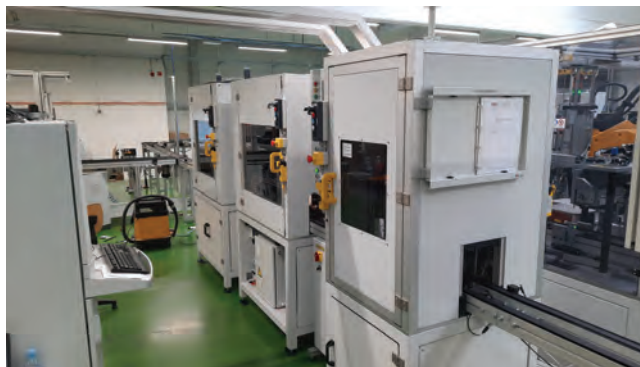
Slika 4: Novi diagnostični sistem za avtomatsko končno kontrolo elektromotorjev v Domelu
