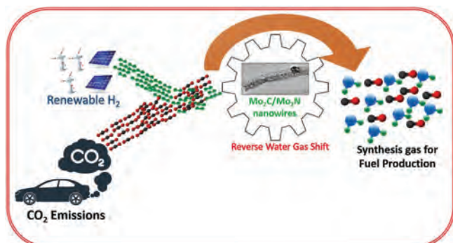
Slika 5: Globalni ogljični odtis je mogoče zmanjšati z zajemanjem, shranjevanjem in uporabo CO 2 za proizvodnjo goriv s pomočjo različnih tehnologij. Zelo obetavna pot je uporaba postopka Fischer-Tropsch, ki poteka v enem reaktorju hkrati s povratno reakcijo vodnega plina (RWGS) z ogljikovim dioksidom in vodikom kot dovodno mešanico. Reakcija RWGS CO_2 + H_2 \leftrightarrow CO + H_2O je ravnotežna reakcija in zaradi svoje endotermne narave omejena na visoke temperature, zato je treba razviti stabilne, aktivne in selektivne katalizatorje, ki bi omogočili uporabo CO 2 pod sprejemljivimi pogoji.
