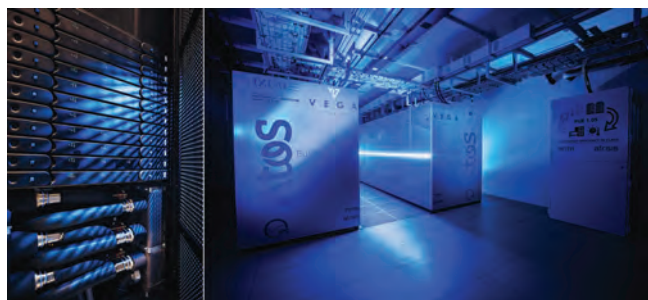
Slika 3: Na IZUM-u je v sodelovanju z ekipo IJS začel delovati slovenski superračunalniški sistem HPC Vega, prvi od sistemov evropske iniciative EuroHPC. S skoraj 6,8 peta FLOP/s, 20 PB diskovnih kapacitet in širokopasovno povezavo v svet je Vega postavila Slovenijo na 21. mesto na novembrski izdaji svetovne lestvice Top500 po opremljenosti s superračunalniškimi kapacitetami na prebivalca.
