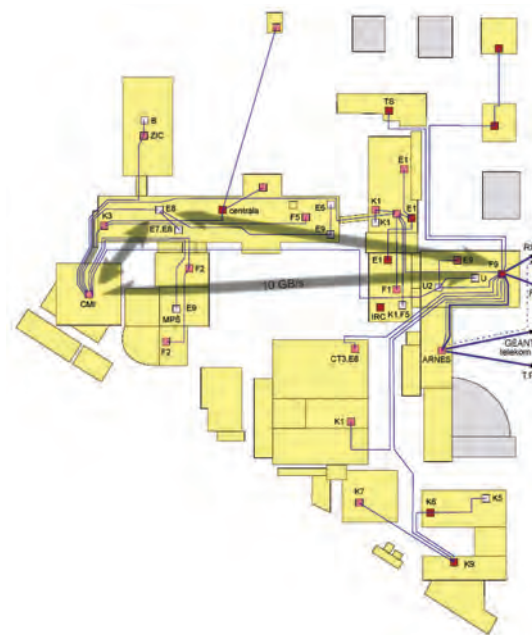
Slika 2: Logična shema komunikacijskega omrežja IJS
