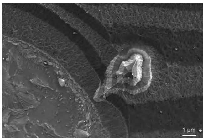
Slika 3: SEM-posnetek defekta na robu kraterja GDOES (razelektiritvena optična emisijska spektroskopija) skozi večplastno prevleko CrN/TiAlN
