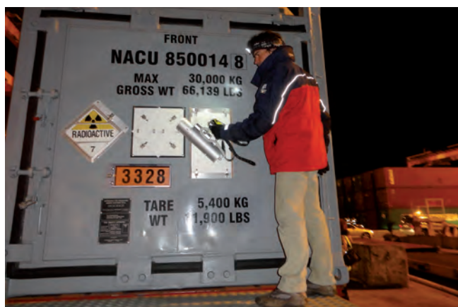
Slika 2: Levo: Meritve pri prevozu izrabljenega jedrskega goriva na relaciji Luka Koper–Šentilj Desno: Meritve ob montaži popravljenega merilnika debeline v podjetju ACRONI, d. o. o., Jesenice.
