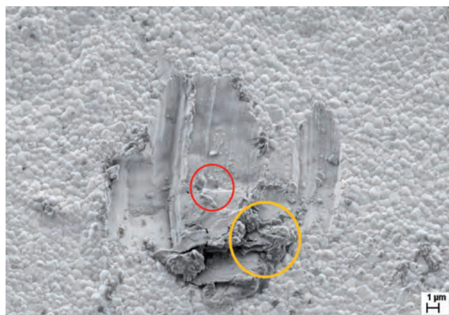
Slika 1: Poškodbe na površini dentalne keramike iz cirkonijevega oksida, ki jih povzroči peskanje. Z rdečo je označena razpoka, ki je nastala kot posledica peskanja, z rumeno pa košček aluminijevega oksida, ki ostane na površini po peskanju.
