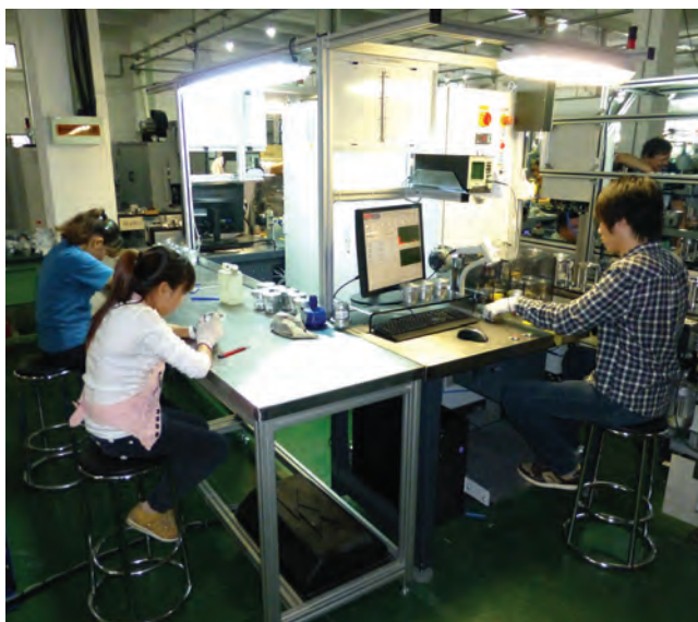
Slika 5: Diagnostični sistem za končno kontrolo elektromotorjev v Domel Electric Motors Suzhou Company Ltd.
