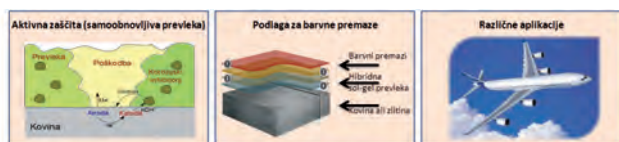
Slika 2: Shematski prikaz hibridne prevleke, ki vsebuje korozijski inhibitor. Prevleka ima lastnost samoobnovljivosti, tj., ko je prevleka poškodovana, se inhibitor aktivira in popravi poškodbo. Prevleke, ki jih nanesimo na kovinske podlage, so lahko osnova za nanos različnih barvnih premazov. Hibridne prevleke so primerne za materiale, ki se uporabljajo v avtomobilski in letalski industriji.
