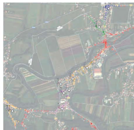
Slika 4: Optimalna lokacije prehodov, določena s programskim orodjem TopoSWiM za načrtovanje topologije obsežnih brezžičnih zankastih omrežij.
