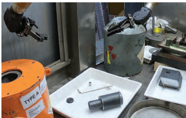
Slika 10: Manipulacija novega vira ^{137}\text{Cs} v vroči celici Reaktorskega centra IJS. V letu 2020 smo vstavili dva visokoaktivna vira ^{137}\text{Cs} in ^{60}\text{Co} v obsevalno napravo Nacionalnega laboratorija za dozimetrične standarde in tako zagotovili prenovo sevalnega polja nacionalnega etalona za ionizirajoče sevanje.
