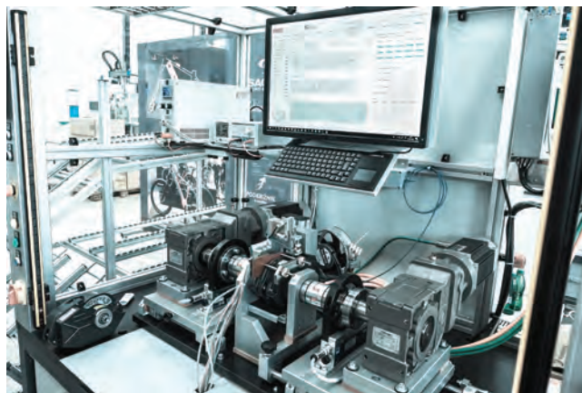
Slika 5: Diagnostični sistem za končno kontrolo pogonskega sklopa za električno kolo
