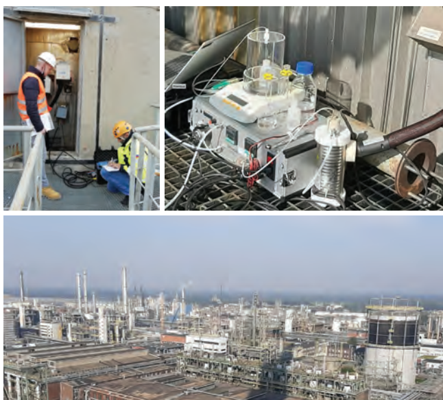
Slika 1: Kalibracije emisijskih meritev živega srebra s sledljivimi metodami kalibracije, ki so bile razvite pri projektu MercOx, smo uporabili pri meritvah na terenu v Salonitu Anhovo (zgoraj) in v termoelektrarni v Marlu, Nemčija (spodaj).
