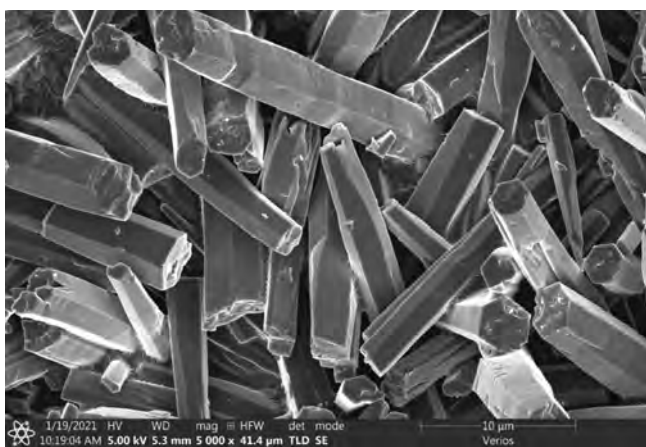
Slika 6: SEM-slika kristalov aragonita \text{CaCO}_3 (Samardžija, Z., K7, Verios 4G HP)
