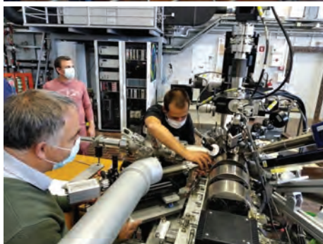
Slika 6: Instalacija novega detektorja rentgenskih žarkov s prečnim zbiranjem naboja (angl. Silicon Drift Detector) na pospeševalniku IJS. Štirje segmenti detektorja so postavljeni v anularni geometriji in pokrivajo ekstremno velik detekcijski prostorski kot 1 steradiana.
