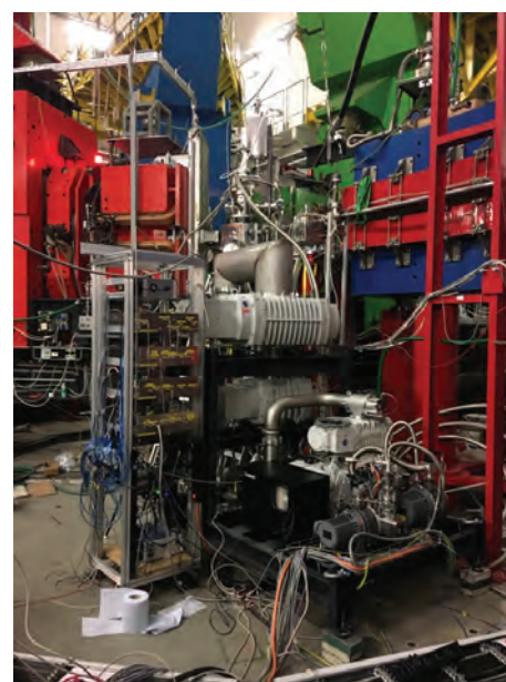
Slika 1: Nov plinski tarčni sistem v obliki hipersoničnega curka kolaboracije A1 na Mikrotronu v Mainzu (MAMI), ki bo v naslednjih letih omogočal visokoprecizijske študije jeter z elektroni.
