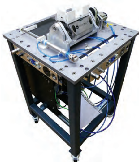
Slika 2: Standardni modul za izgradnjo rekonfigurabilne robotske celice
