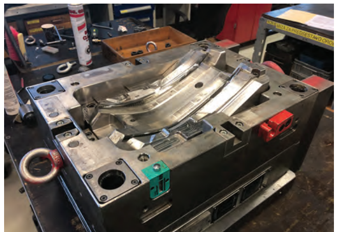
Slika 1: Za boljše načrtovanje proizvodnje orodij za tlačno litje smo razvili programsko rešitev za napovedovanje trajanja obdelovalnih operacij, ki temelji na pridobivanju značilk iz prostorskih risb orodij in strojnem učenju napovedi na osnovi teh značilk.
