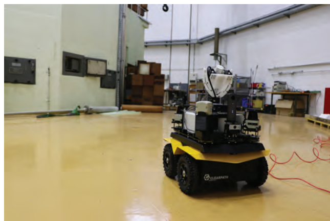
Slika 1: Testiranje robota, ki samodejno izmeri dozno polje prostora.
