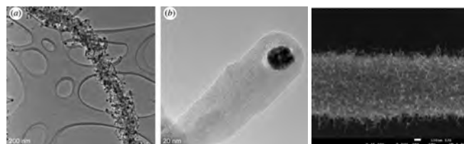
Slika 5: TEM-slika ogljikovih nanovlaken, zrasih na molibdno karbidnih nanožicah. (a) Nanožica, pokrita z vlakni; (b) posamezno ogljikovo nanovlakno z nanodelcem Mo 2 C. SEM-slika hibridnega materiala.
