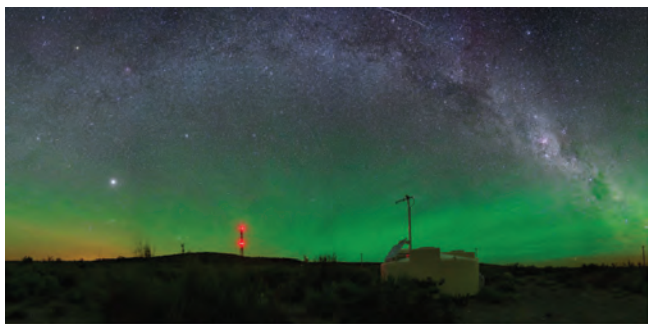
Slika 6: Slika kaže enega izmed 1600 Čerenkovih detektorjev Observatorija Pierre Auger. V ozadju se vidi komunikacijski stolp, ki skrbi za zajem in prenos podatkov. Mreža detektorjev prekriva površino 3000 km².
