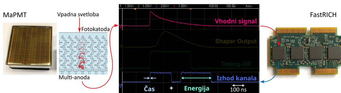
Slika 3.3: Način štetja fotonov s časovno informacijo. ( levo ) Vpadni foton povzroči plaz elektronov znotraj fotopomnoževalke MaPMT, kar povzroči hiter tokovni pulz na enem od izhodnih kanalov. ( sredina in desno ) Pulz iz detektorja pride na vhodni kanal čitalnega čipa. Slednji se odzove z dvema digitalnima pulzoma: prvi označuje čas prihoda, drugi pa velikost prejete energije, oz. število zaznanih fotonov. Prikazane signale so izmerili s čipom HRFlexToT [22], predhodnikom čipa FastRICH. Čipi, prikazani na desni, so FastIC [23], ki so trenutni prototip novega sistema. Čipi FastRICH še niso na voljo. Povzeto po [4] in [24]
